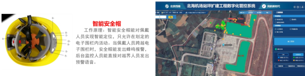
图 18 人员安全管控平台界面
