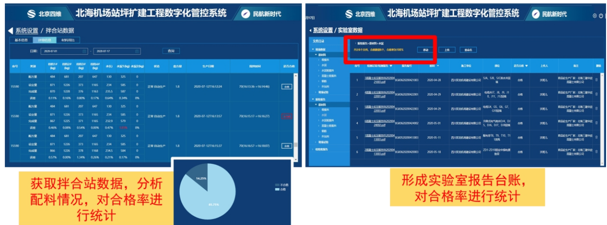
图 30 拌合站和实验室数据监控平台
