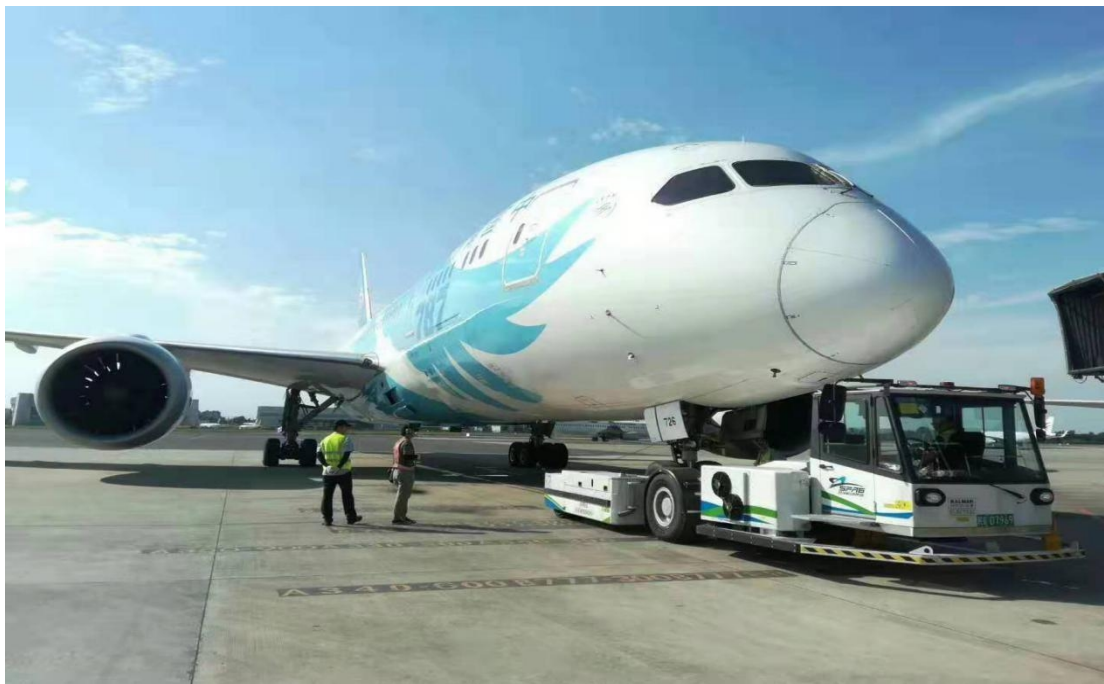
图 2 双流机场电动飞机牵引车保障航班
