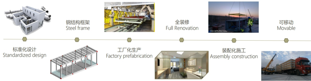
图 2 装配式模块化建筑设计建造流程图
