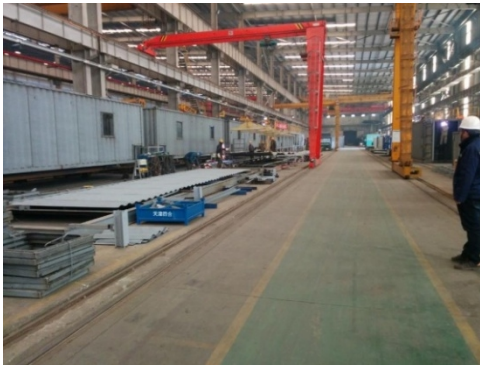
图 21 箱体工厂模块化生产
