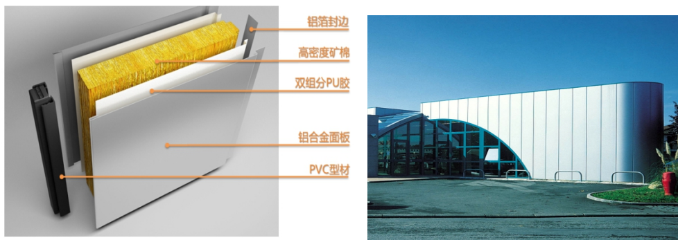
图 5 夹心墙体板结构
