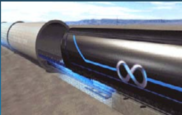
“超级高铁” 胶囊车身+真空管道+磁悬浮
